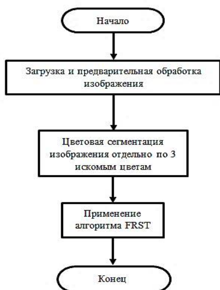
Рис. 4. Блок-схема алгоритма обнаружения и распознавания сигналов светофоров
